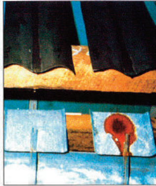
Photo 3 Acier galvanisé prépeint vers acier à revêt. Al/Zn (gauche). Acier galvanisé prépeint vers acier gal- vanisé (droite).
